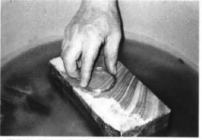
写真10 砂石で研磨すると金属光沢が出る
