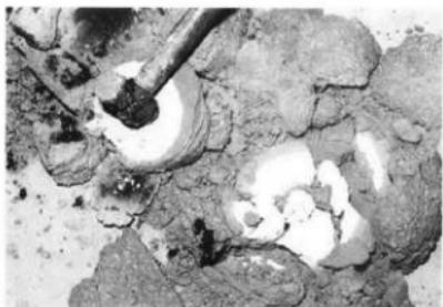
写真7 冷えたら鋳型を壊し、鋤を取り出す
