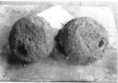
写真5 湯口を残して荒真土で周囲を固定
