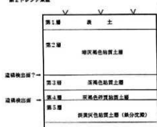
第2トレンチ調査
