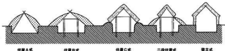
図135 竪穴式住居断面模式図（宮本1988より）
