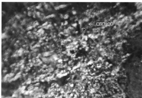
C 基部の腐蝕痕と摩耗・光沢痕 × 50
