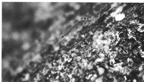
2B 刃部の摩耗・光沢痕(2Aの拡大) ×100
