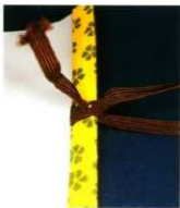
見返しの端に平紐をボンドでつけたあと平紐の反対側を表紙側から通す。
