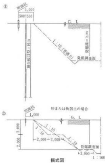
図5 鋼矢板の設置
