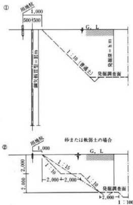
第5図 鋼矢板設置標準図及び発掘面
