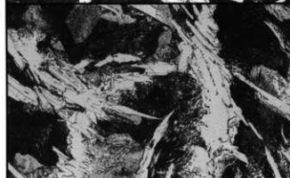
Photo.3 炉内滓 (含鉄) の顕微鏡組織
