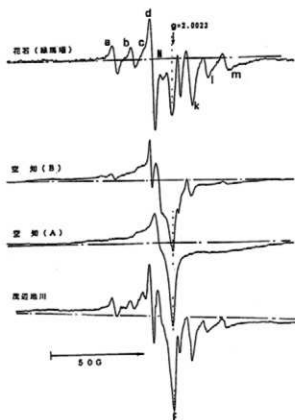
図 11-3 碧玉原石の信号Ⅲの ESR スペクトル
