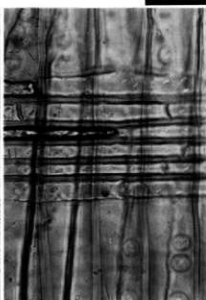
9. クロベ (放射断面) 97B-W-019 bar:0.05mm
