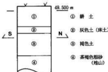
図4 基本土層柱状図 (S : 1/10)
