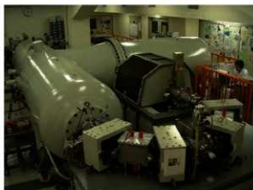
写真13 オランダ High Voltage Engineering Europe (HVEE) 社製のタンデロン 3MV-AMS システム
