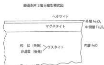
第 74 図 FeO 系平衡状態図、および鍛造剥片 3 層分離型模式図
