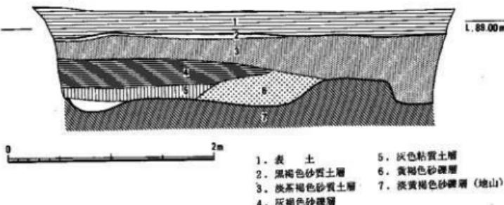
第3図 発掘区東壁堆積土層図 (1/40)
