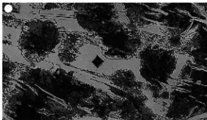
Photo7 鉄塊系遺物の顕微鏡組織
