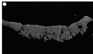
Photo10 椀形鍛冶滓・附着鍛造剥片の顕微鏡組織
