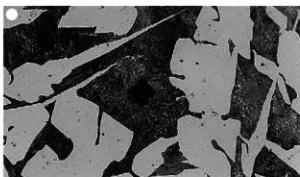
Photo9 鉄塊系遺物の顕微鏡組織
