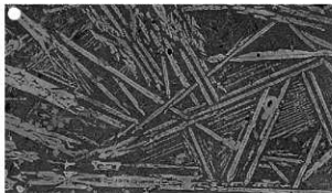
Photo8 梘形鍛冶滓の顕微鏡組織
