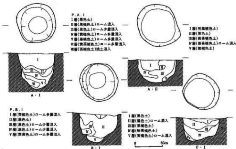
第34図 摂立建造物址柱穴地層断面図
