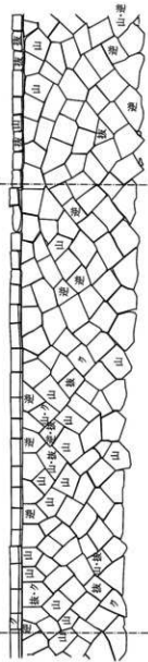
破損石材区分図
