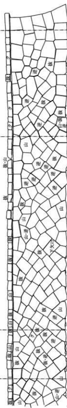
破損石材区分図
