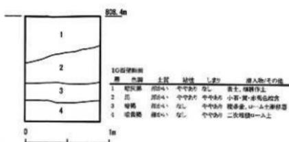
第41図 1グリッド西壁断面図 (S=1/40)
