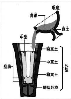
第3図 鑄型構造図
