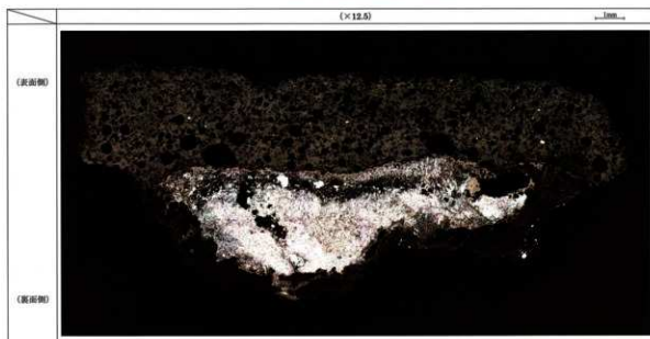
第11図 真土片に付着した金属塊試料 (M5208) の断面状況観察
