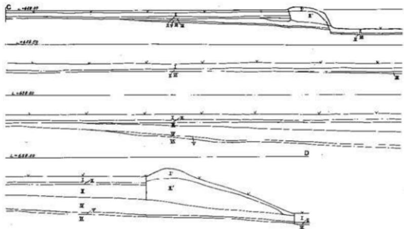
第6図 23-き~49-き (C-D) 地層断面図 ( $S = \frac{1}{100}$ )
