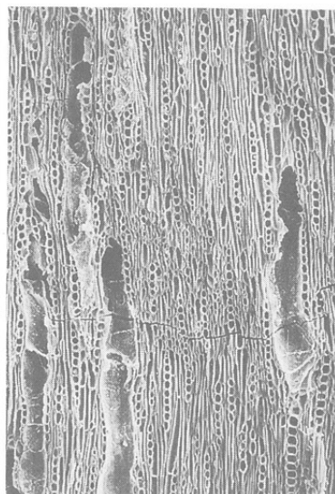
3b クリ (接線断面) 試料6 bar: 0.5mm
