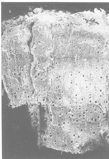
5 a クロモジ属 (横断面) 試料 7 bar : 0.5mm
