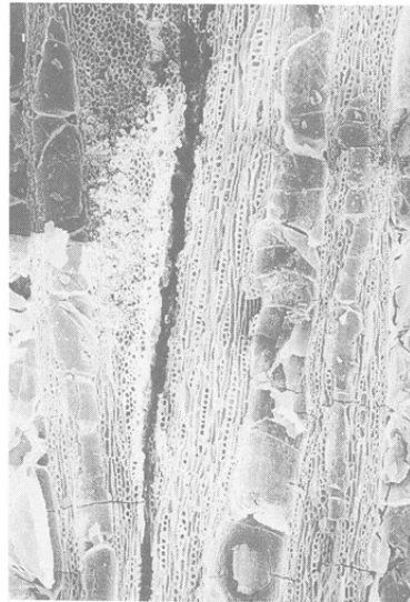
2b コナラ節 (接線断面) 試料1 bar: 0.5mm
