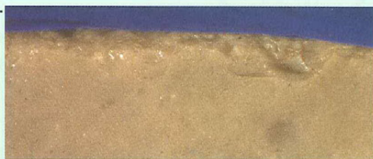
193 折れ面の縁の摩耗 (写真の幅=7mm;実物の10倍)
