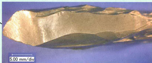
194 槍の折れ面 (写真の幅=4cm;実物の1.75倍)
