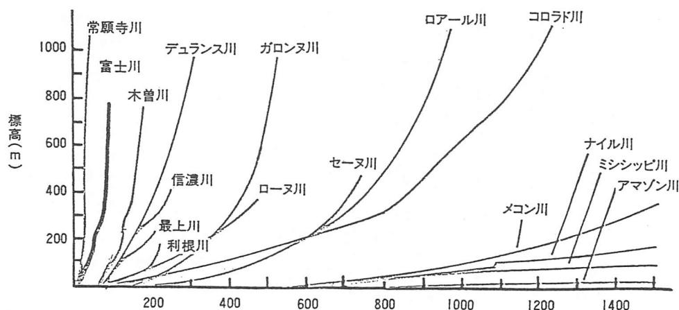
第5-2図急流河川の縦断図
