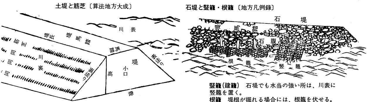
**川除堤** 土堤の図である。川に面した側を川表、反対側を川裏、頂面を馬踏、底面を敷、斜面を法(のり)と呼ぶ。
