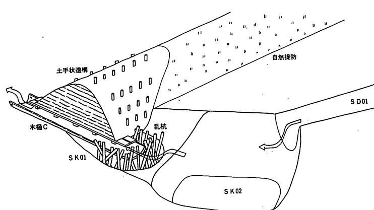
堤体部には人為的な盛土は見られず、河川の流入によって形成された砂層の微高地を堤防の本体としている。馬踏部中央と両側端部に3列の杭列をうち、両側端の杭には3~4mの横木を組んで法肩とし、法部の杭と横木に樹皮を絡ませて補強している。また、堤防の西端部がくちばし状に先端が尖り横木や杭は認められないが、木葉様の有機物を多く含む粘質土が10~20cmの厚さで覆い法面を保護している。
