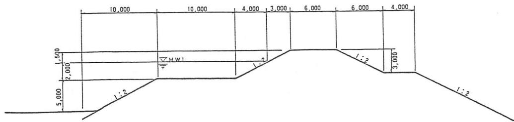
第5-9図 釜無川堤防標準溝断面図
