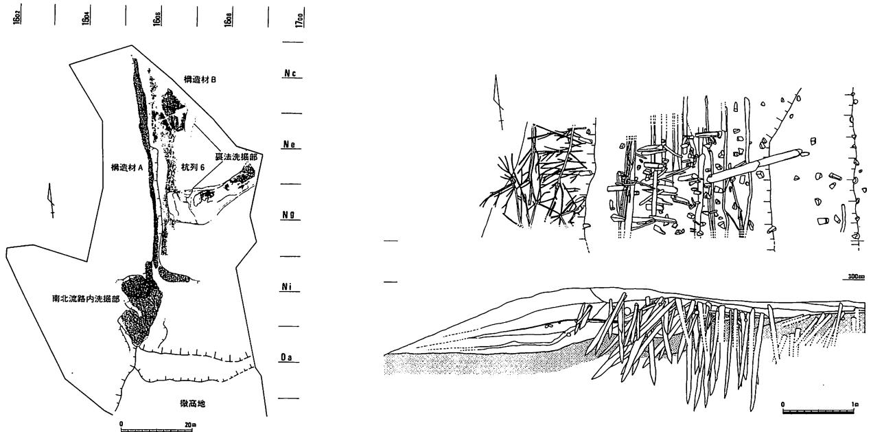
第1-5図 津寺遺跡の護岸施設配置図（左）と護岸施設平面・立面・断面（Jライン）
