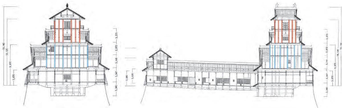
宇土櫓断面図（青色は2・3階の通柱、赤色は4・5階の通柱）
