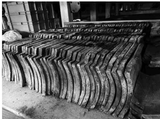
既存棧瓦 打音検査合格瓦 一八四枚
