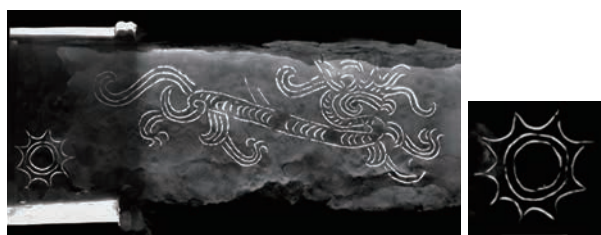
図6 島内114号墓出土銀装大刀のX線CT画像 連弧輪状文と龍文象嵌
