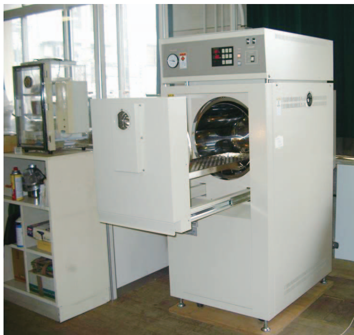
写真2 脱塩処理装置
