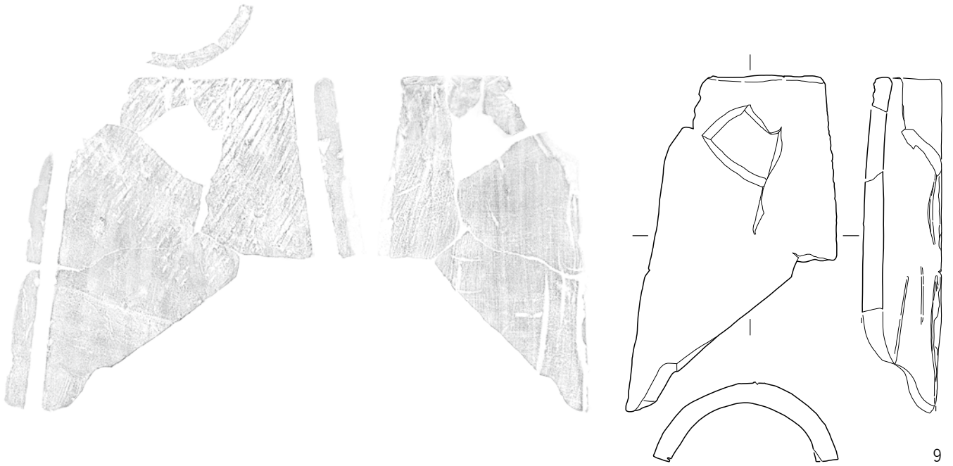
丸瓦 無段式 粘土板桶巻づくりⅠ類
