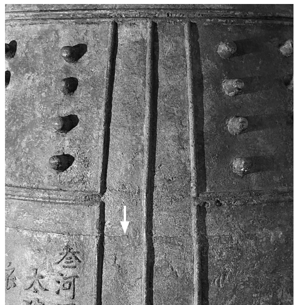
図 21 鑄型（外型）継ぎ目
