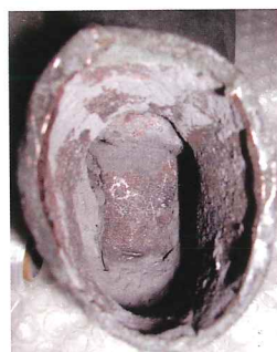
写真 99 爪先側の中子砂の除去がほぼ終了
