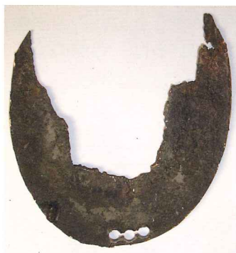
写真 47 左足首側 ホゾ取り付け部分 切除片 内面
