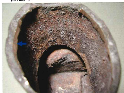
写真 101 中子砂を全て除去後爪先側の内部
