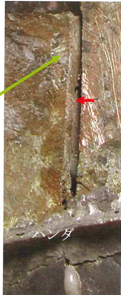
写真 26 白矢印 切削加工面
