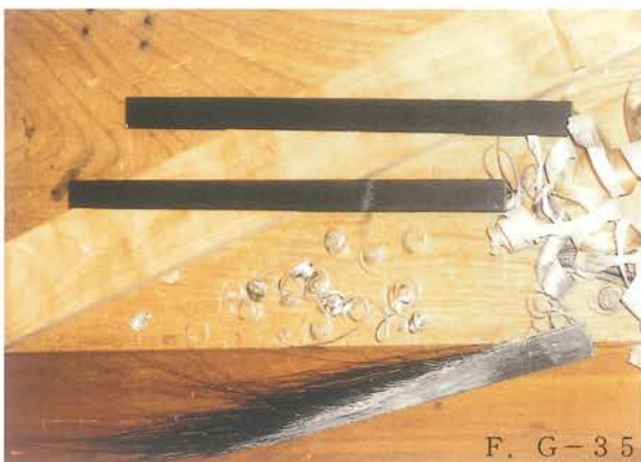
F. G-35 ヒゲバネの加工 良質なバネが削り取れた様子。
