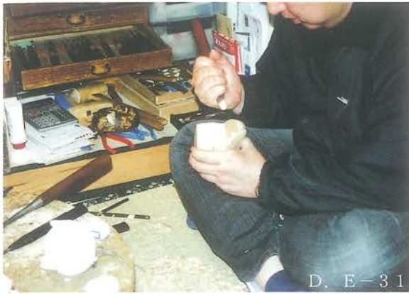
D人形（玉藻之前） 狐の頭部粗彫 狐の頭部はキリを素材にして製作。 内部を削り貫けない形状の為、軽量のキリを使用している。
