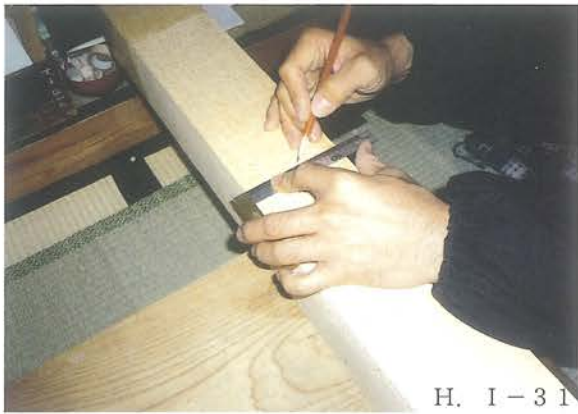
H人形（藤太） 頭素材切り出し ヒノキを木取る所。 ヤニの少ない目の通った素直な材を用意。
