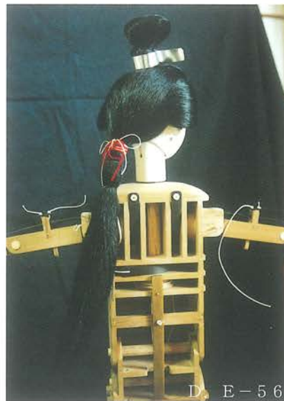
E人形（侍女） 胴体完成 一通りの部品を取り付けてみて 動作を確認してみる。 問題なければ正式な操作糸が貼 られる。糸は絹糸を使用。
