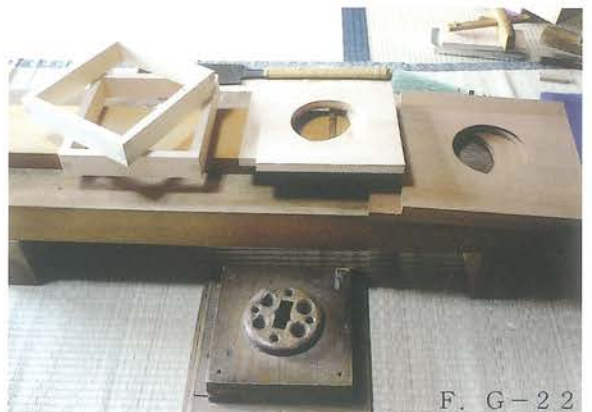
F. G人形（童子・Zen和尚）の台車 枠はヒノキ、下の板はサクラを使用。 全ての寸法が歪みの為（一部割れ）、 バラバラであったので、平均値を出し製作。
