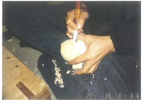
H人形（藤太） 頭 寸法通りに木取りを済ませたヒノキを粗彫りしている様子。鋸を数種類の鑿を使い分けて大まかな顔の表情を彫って行く。
