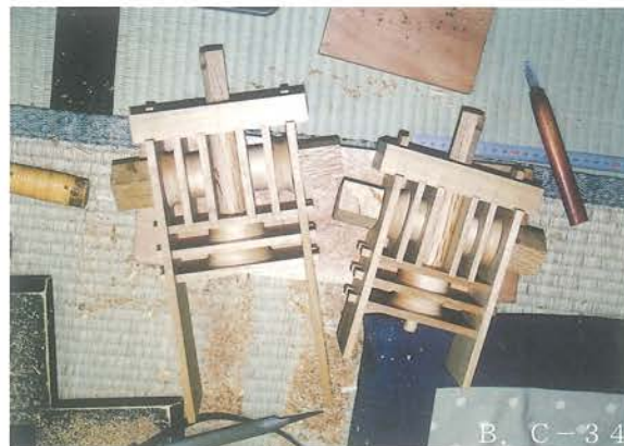
B. C人形の胴 横遣いの胴の方がやや大きい寸法。 肩軸や首の軸や関連の部品を仮組みして見て円滑に動作する事を確認する。
