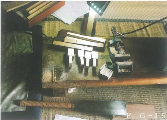
F. G人形（童子・玄翁和尚）の肩軸 カシで肩の軸（腕の付け根）を製作。 寸法、構造は2体共同じ為、共通の部品として 作る。首の軸も同時に作り進める。
