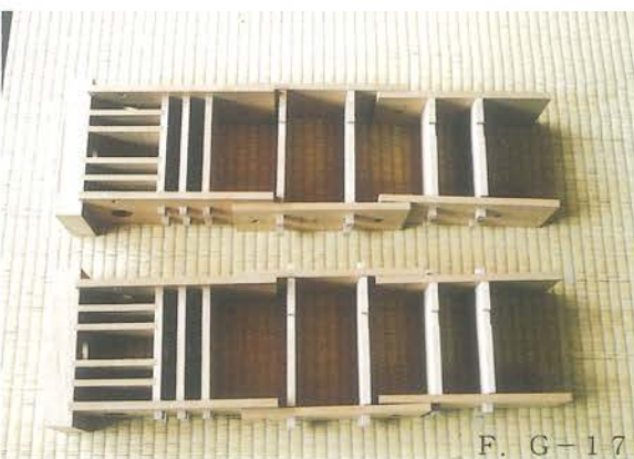
F. G人形（童子・玄翁和尚）の胴体 胴体の木組みが一通り出来たら、しばらく組ん で置いておく。歪みが生じた所があれば、調整 し直す。
