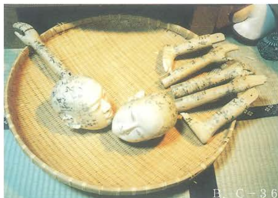
和紙貼り作業 胡粉を塗る下準備として古い大福帳の和紙を糊で貼る。割った後の補強とヒノキのヤニ止めの意味で入念に貼る。糊はデンプン糊を使用。
