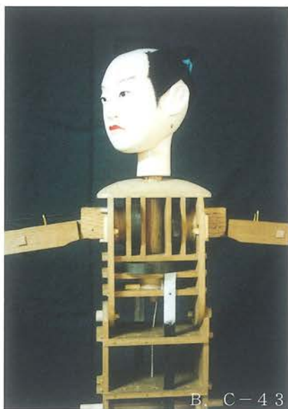
B人形（忠信）の上半身 仕上がった頭を胴体に乗せる。 この時に滑らかに首が回るか、 ゼンマイバネの強さを調整。 忠信の髪はカツラではなく、 直接頭に植え付ける。 素材は人毛。
