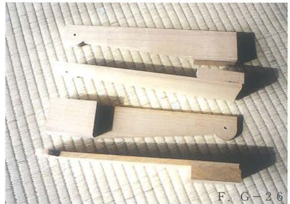
F. G人形（童子・玄翁和尚）の足 太ももになる部分。サクラを貼り合わせて製作。 接着が乾いた後で削って形を整える。
