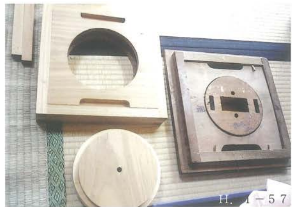
H人形（藤太） 台車 新調を進める途中で、オリジナルの台車と並べて、大きさや特徴に差がないか確認している様子。
