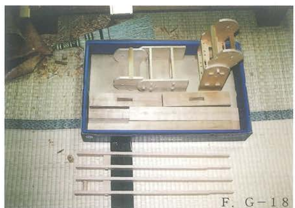
F. G人形（童子・玄翁和尚）の胴体 胴体と共に立棒（支柱）も作り始める。台車下 の立棒はサクラで作り、人形側はカシで作る。
