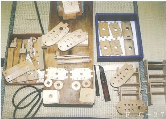
F. G人形（童子・玄翁和尚）の部材 1つ1つ部材を確認しながら面取りや、角を丸 く削って仕上げて行く。この時点で糸穴等は空 けておく。
