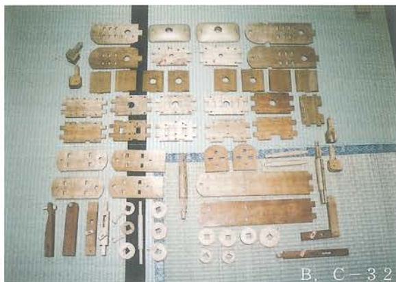
B. C人形 胴体一通りの部材 2体の構造は良く似ているが、若干寸法が異なる為、間違えない様に部品を製作。
