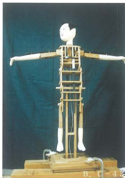
B人形（忠信）の完成 台車に載せてみて、実際に一通 り動かす。不具合等無ければ、 正式な絹糸を通して完成。
