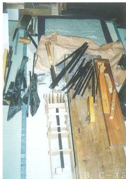
バネやゼンマイに使用するセミクジラのヒゲを鋸で切り出して必要な寸法や幅、厚みに鉋で削って加工する。 貴重な素材だけに注意して加工する。
