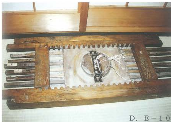
D人形（玉藻之前）台車部分 中央の軸部の磨耗が著しい。長年の使用の為、糸で擦れてしまい、演技中に糸が切れ易くなっている。
