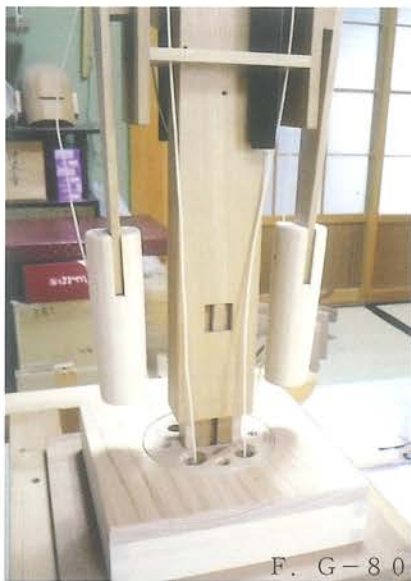
G人形（玄翁和尚）台車と足 中央の筒の四角い小窓に、立棒のツメが掛かっているのが見える。
