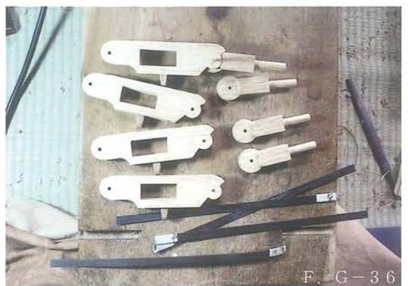
F. G-36 F. G人形（童子・玄翁和尚）の腕 肘の関節に使用するバネを巻く前の様子。 微妙な加減が難しい作業。
