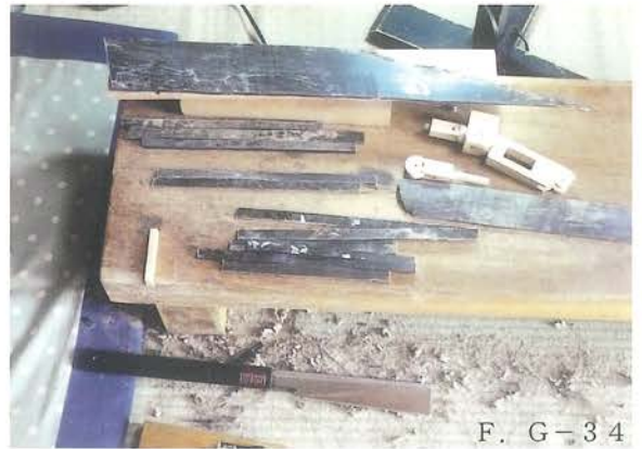
F. G-34 クジラヒゲの加工 各部位に見合った寸法のバネを製作している所。 長さ、幅、厚みや強さを鉋で削って決めて行く。
