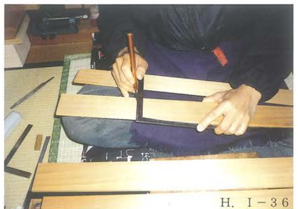
H. I人形（藤太・弁財天） 胴 実物から採寸し、新しい材に必要な部分の印しを付けている様子。
