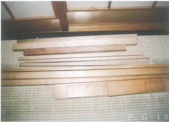
F. G人形（童子・玄翁和尚）使用の材（部分） 素材は主にサクラとカシ。 台車はサクラとヒノキとクス。
