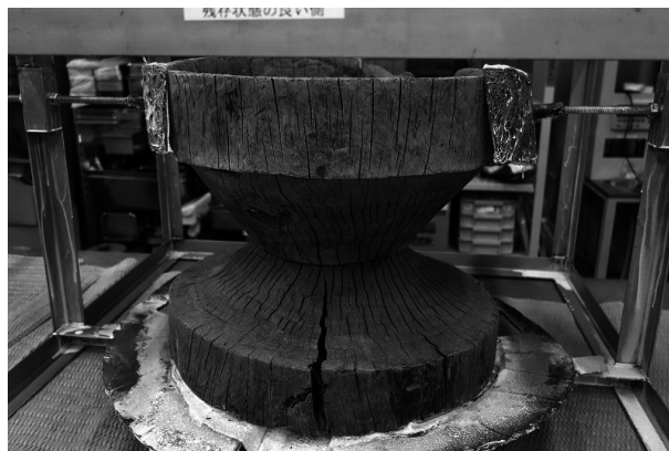
図6 真空凍結乾燥終了直後の白の様子
