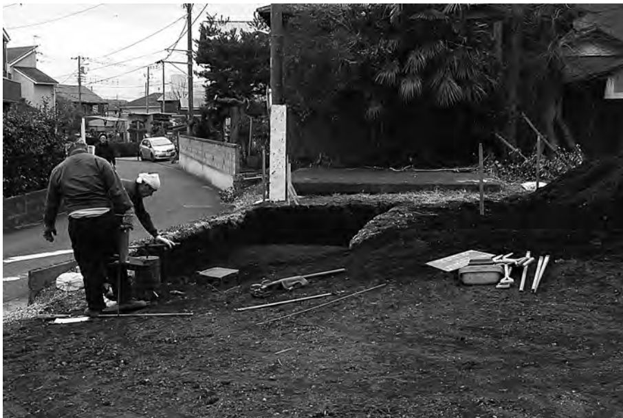
写真1 スウェーデン式地盤調査作業状況
