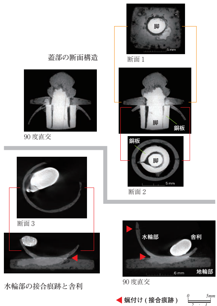
写真1 金銅製舍利容器X線CT画像
