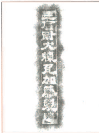
拓本-3 第一煙突足元より出土の耐火煉瓦 刻印（煉瓦外形 232 × 110 × 65mm）
