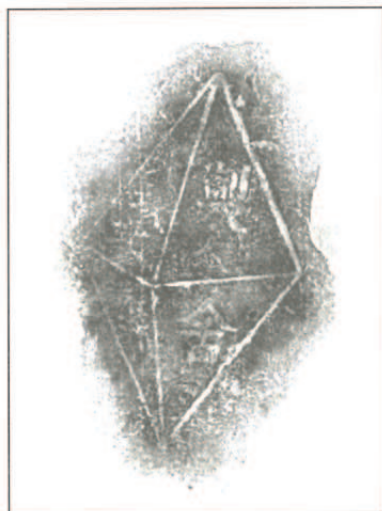
拓本-1 第一煙突足元より出土の耐火煉瓦 刻印（煉瓦外形 228 × 110 × 65mm）
