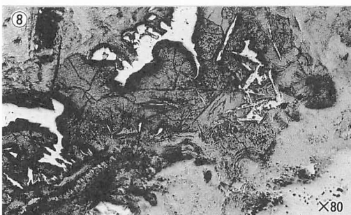
Photo 1 鉄斧 (酸化組織) の顕微鏡組織 ②・③ 同一視野 ④・⑤ 同一視野 ⑧・⑨ 同一視野
