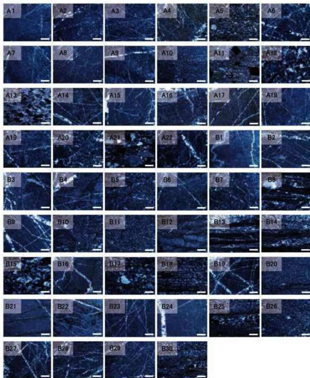
Fig.146 本丸石垣に用いられた調査対象石材の偏光顕微鏡写真(クロスニコル、スケールバー：0.5mm)
