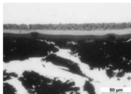
Fig.17 クリ素地の断面構造 (19 内面)
