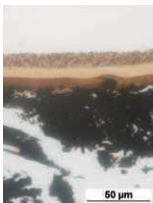
2 漆器碗 (19) 漆塗膜構造
