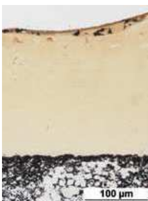
4 漆器碗 (20) 漆塗膜構造
