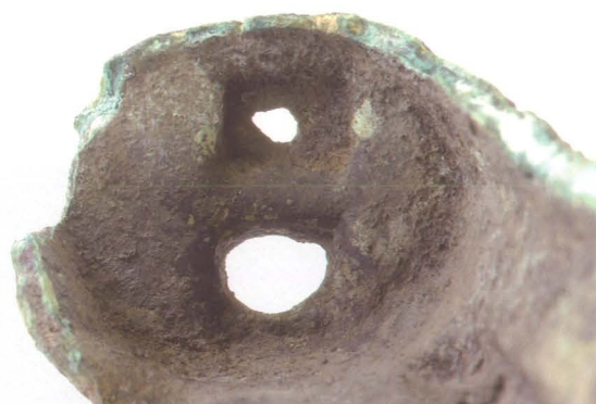
舞裏面側からみた方形の型持孔とその欠陥
