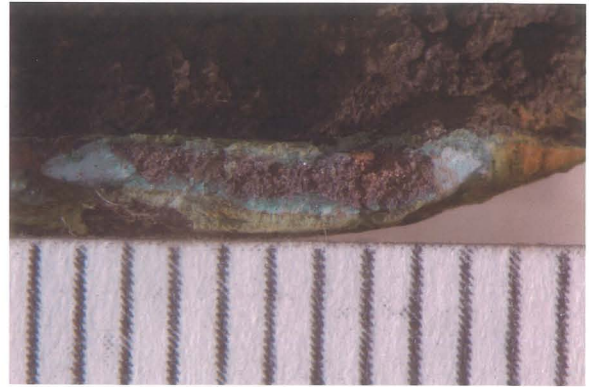
B面左側身上部破断口
