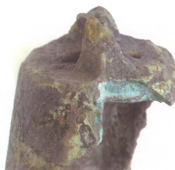
鈕基部とA・B面の鑄合わせ状態
