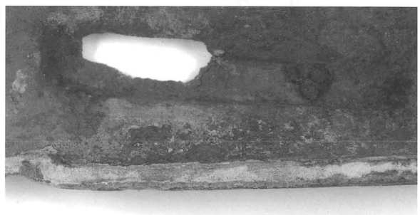
第4図 鈕基部とA・B面の鑄合わせ状態
