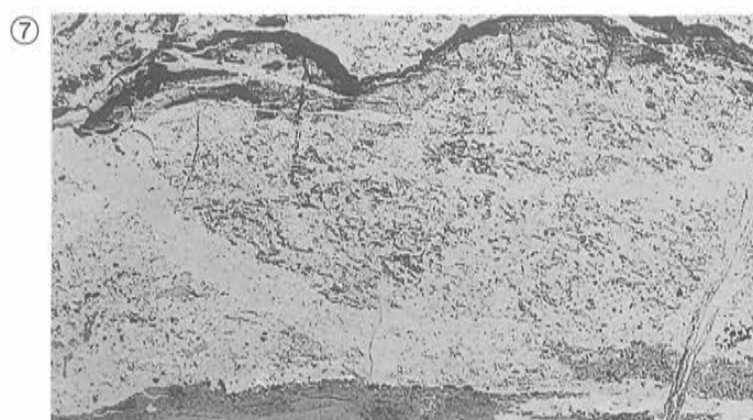
Photo.6 不整形形状鉄片と三角形状の顕微鏡組織
