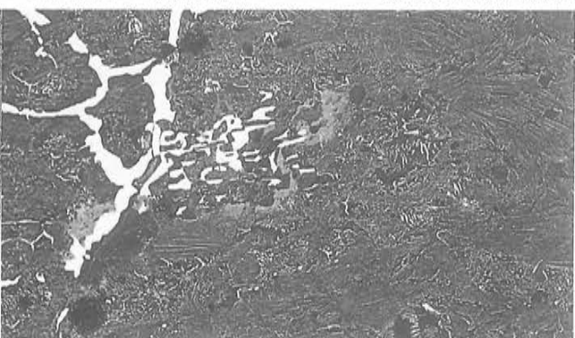
Photo.12 袋状鉄片と棒状鉄片の顕微鏡組織
