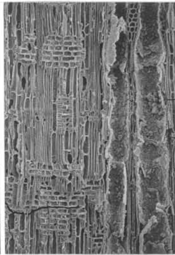
1c アカガシ亜属 (放射断面) No.8 bar:1.0mm
