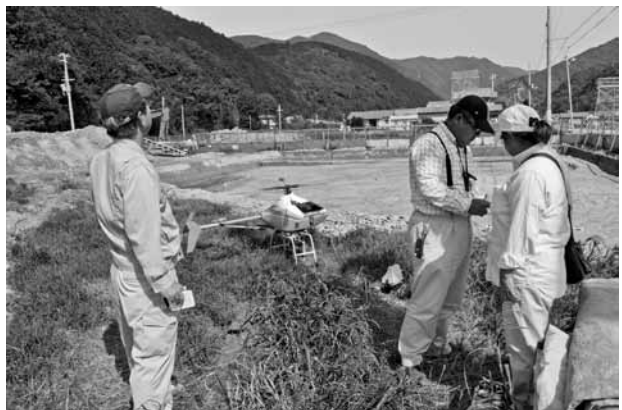
写真12 ラジコンヘリによる航空写真撮影・測量
