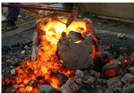
炉を壊してケラを取り出す
