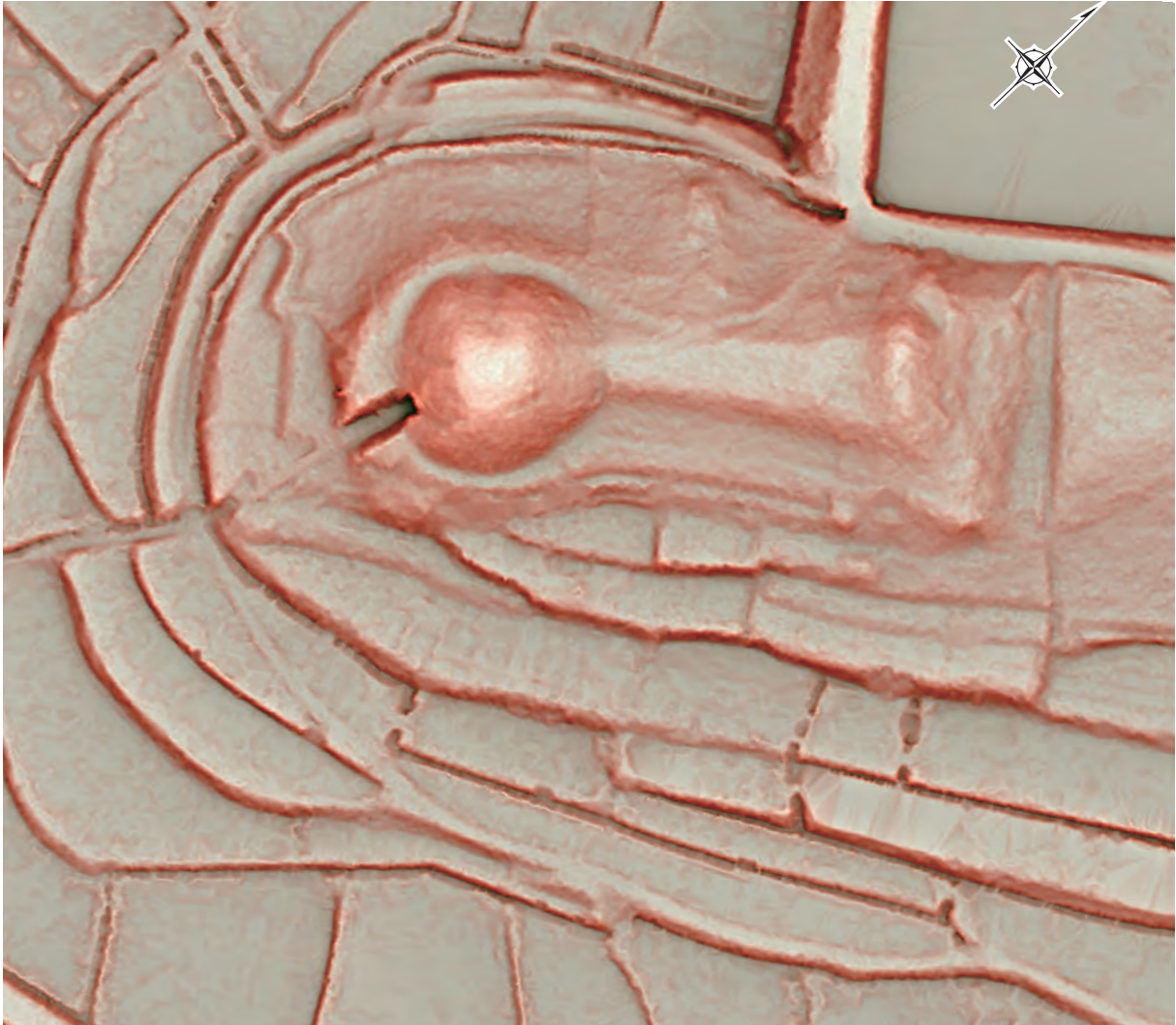
1 こうもり塚古墳墳丘測量図 (1/1,000) 航空レーザ測量による赤色立体地図
