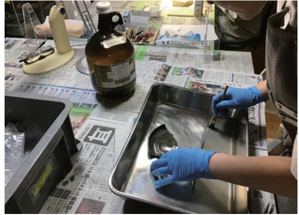
⑥洗浄作業（有機溶剤での土砂・油分除去）
