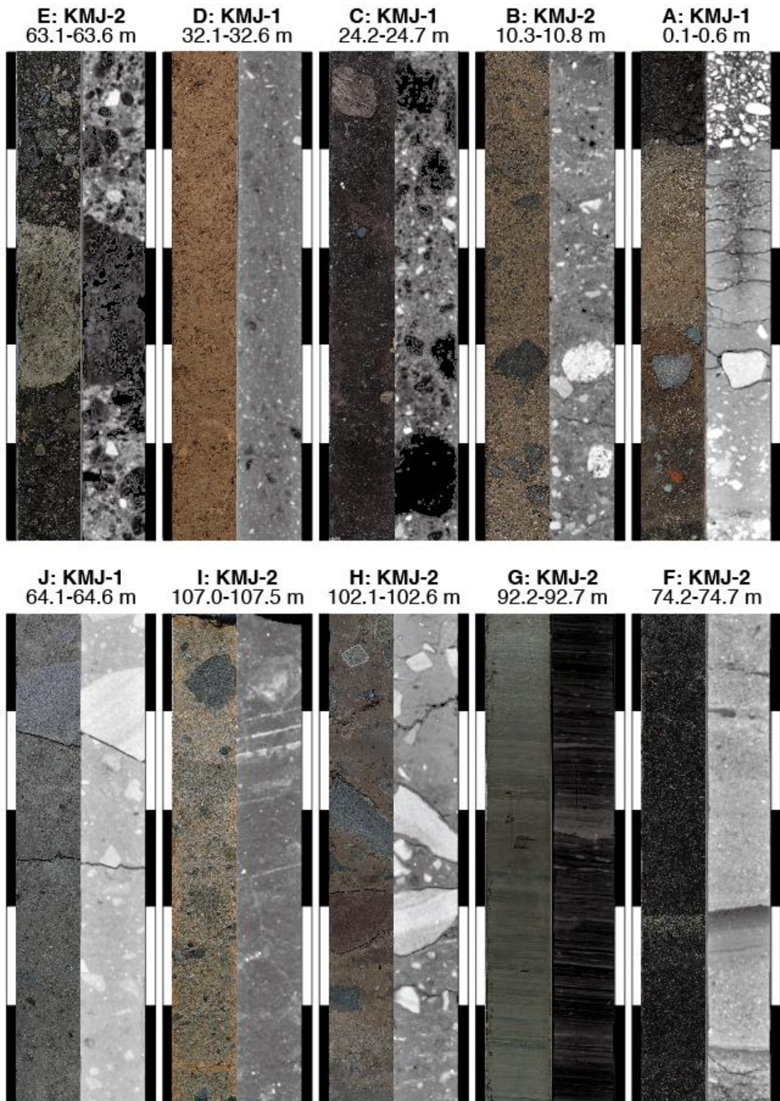
図 9. 熊本城公園で採取した柱状地質試料（左：写真，右：CT 像）
