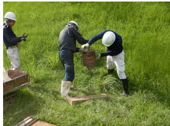
写真2 西出丸北側空堀サウンディング試験
