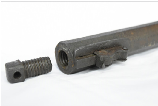
八板金兵衛清定が製作に苦勞した雌ねじ（右）
