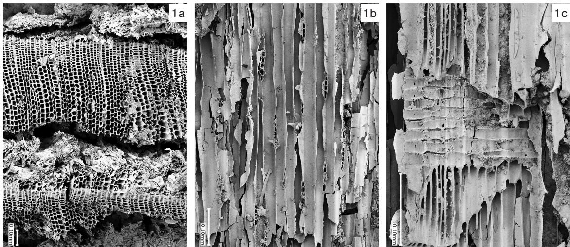
図96 炭化材の走査型電子顕微鏡写真
