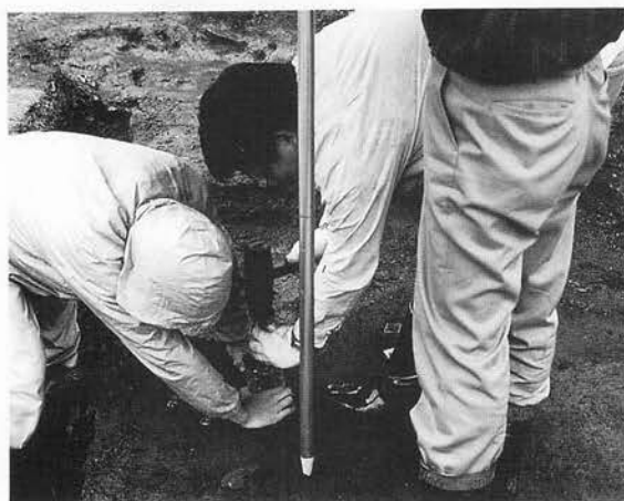
熱残留地磁気測定サンプル採集
